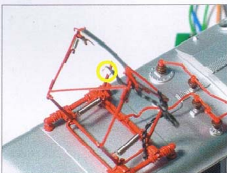
Das Kabel vom Pantografen-Blitz wird um das Gestänge des Stromabnehmers herumgewunden.
