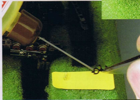
Der Kupplungszapfen zur Aufnahme der Feder erhält einen Tropfen Öl, ...
