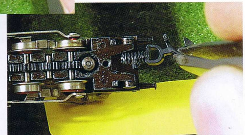
Der Kupplungszapfen zur Aufnahme der Feder erhält einen Tropfen Öl, ...
